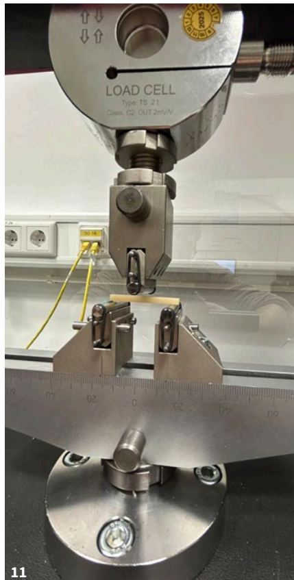
Abb. 10 Untersuchung verschiedener Bearbeitungsparameter und deren Einfluss auf das Zirkonoxid (5Y-TZP). Abb. 11 3-Punkt-Biegeprüfung (DIN EN ISO6872:2019) mit Universalprüfmaschine. Abb. 12 und 13 CAD-Modell der Spannvorrichtung für die maschinelle Bearbeitung der Prüfkörper.
