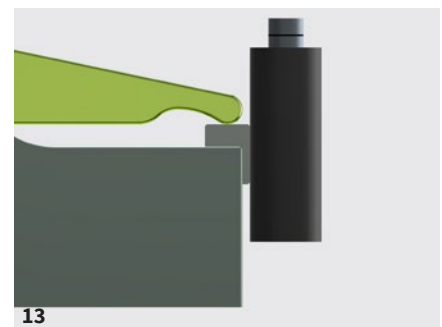
Abb. 10 Untersuchung verschiedener Bearbeitungsparameter und deren Einfluss auf das Zirkonoxid (5Y-TZP). Abb. 11 3-Punkt-Biegeprüfung (DIN EN ISO6872:2019) mit Universalprüfmaschine. Abb. 12 und 13 CAD-Modell der Spannvorrichtung für die maschinelle Bearbeitung der Prüfkörper.
