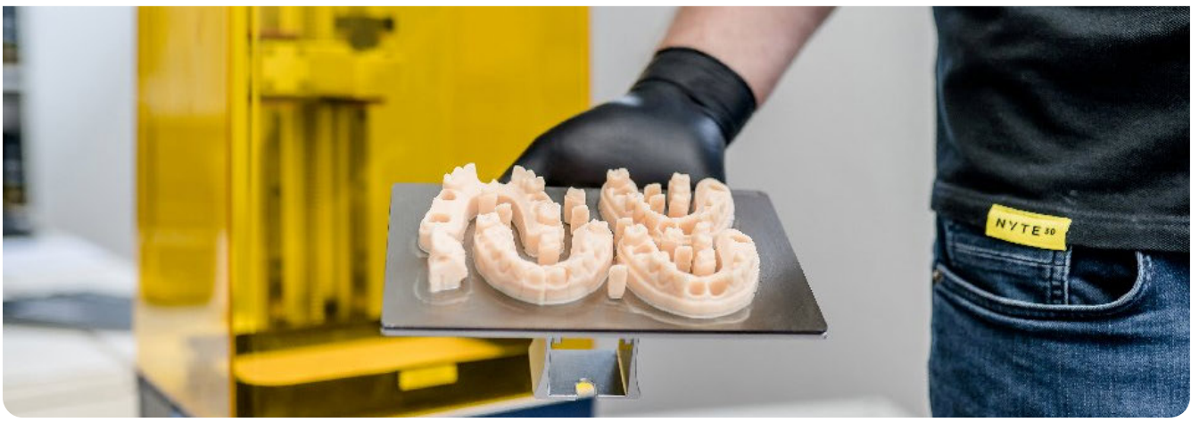
^ 05/06 Modelldruck mit NYTE3D-Model (in verschiedenen Farben erhältlich). Vorteile: Kurze Belichtungszeit und hohe Materialreaktivität für die schnelle Modellherstellung, präzise Zeichnungsschärfe, hohe Festigkeit
