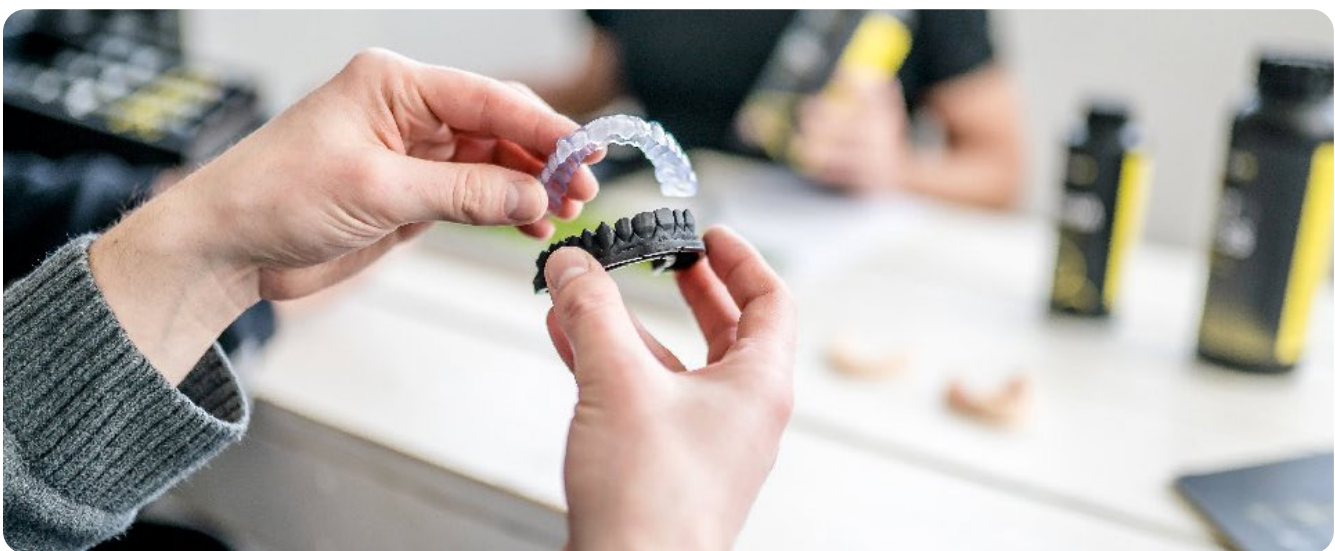
^ 07 Modelldruck mit NYTE3D-Model (in verschiedenen Farben erhältlich). Hier: Modell für die Herstellung einer Aufbisschiene
