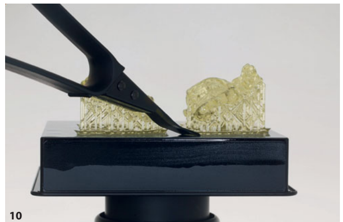
Abb. 7 Gedrucktes Kiefermodell mit knochengetragener Bohrschablone. Abb. 8 Gedruckte Aufbisschiene, eingegliedert am Patienten. Abb. 9 und 10 Gedruckte Objekte auf der Bauplattform unmittelbar nach dem Druckvorgang, die Stützstrukturen müssen im Rahmen der Nachbehandlung entfernt werden.
