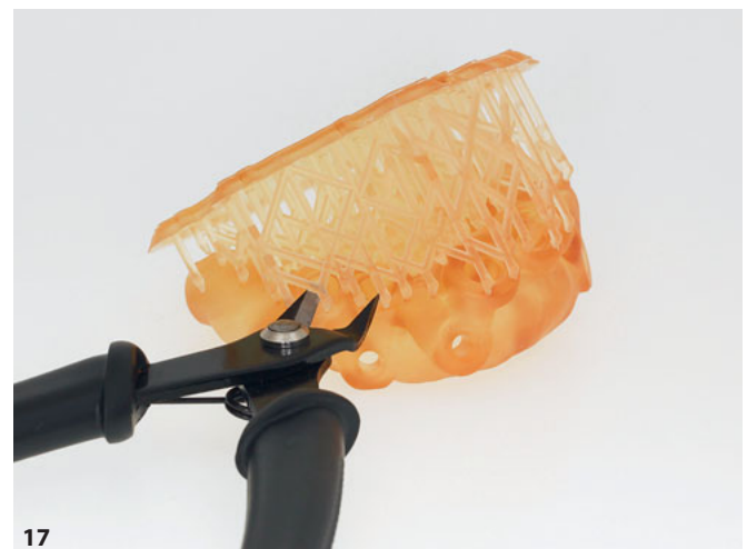
Abb. 16 Gedruckte Bohrschablone vor der Endhärtung im Lichthärtegerät. Das verwendete Material (Nextdent Surgical Guide) hat einen Farbumschlag als Indiz für die Nachpolymerisation. Abb. 17 Gedruckte Bohrschablone nach der Lichtpolymerisation (Farbumschlag orange) beim Abtrennen der Stützstrukturen.
