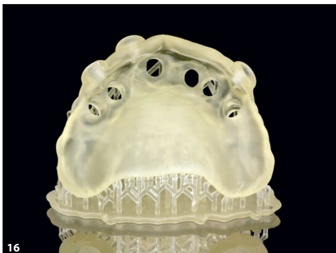
Abb. 16 Gedruckte Bohrschablone vor der Endhärtung im Lichthärtegerät. Das verwendete Material (Nextdent Surgical Guide) hat einen Farbumschlag als Indiz für die Nachpolymerisation. Abb. 17 Gedruckte Bohrschablone nach der Lichtpolymerisation (Farbumschlag orange) beim Abtrennen der Stützstrukturen.
