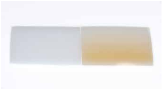
▣6 Opakes Zirkonoxid (li.) und ein Multilayer-Zirkonoxid (re.)
