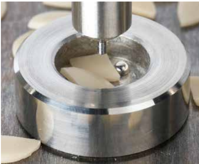
▣4 Biaxiale Prüfung von Zirkonoxid zur Messung der Biegefestigkeit
